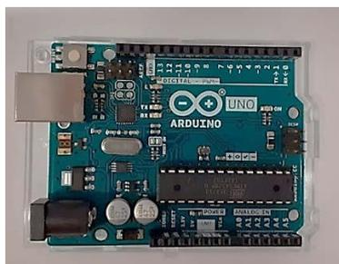
**Fig. 1.** Microcontroller ARDUINO UNO REV3.
