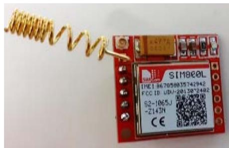
**Fig. 2.** Communication module GSM/GPRS SIM800L.
